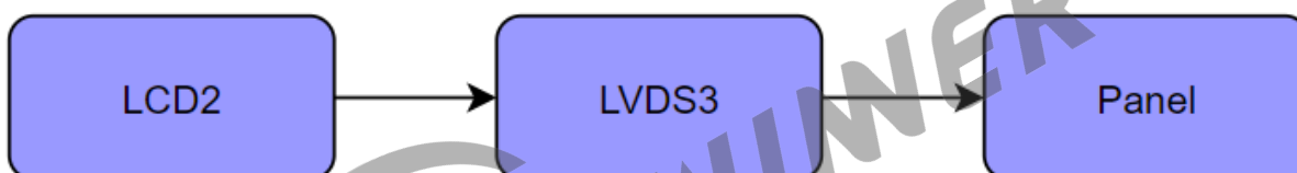
图 7-4: lvds3 输出示意图
