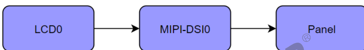
图 6-1: dsi0 输出示意图
