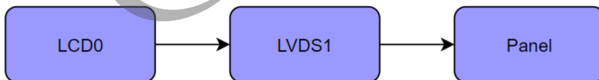
图 7-2: lvds1 输出示意图
