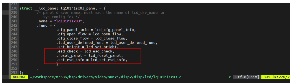
图 13-2: 屏驱动方法结构体配置
