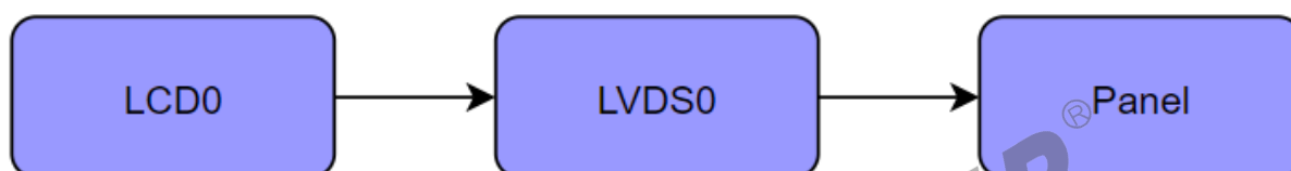
图 7-1: lvds0 输出示意图
